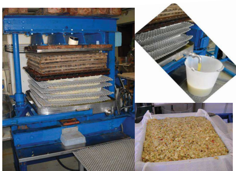
Figure 44 - Photographie de la presse à paquets utilisée pour produire les jus de Dous Moen en grand volume 5
