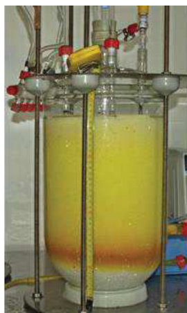
Figure 80 - Purification sur résine amberlite Amberlite™ FPX66 de la fraction colorée résultant de l'oxydation enzymatique de la phloridzine (Photo T. Dugé de Bernonville(Dugé de Bernonville et al., 2011))
