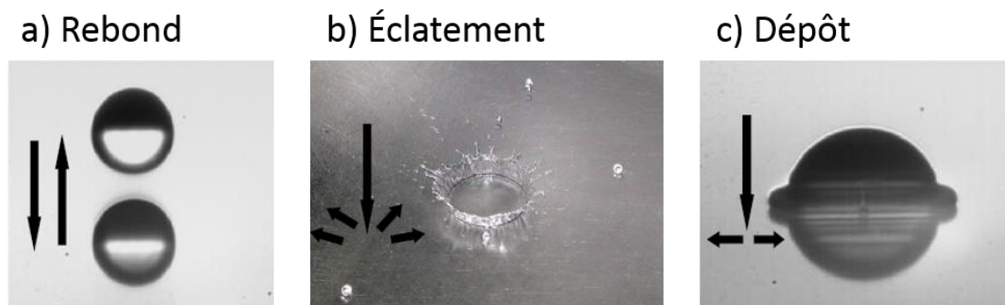
Figure 29 : Les différents comportements possibles lors de l'impact d'une goutte sur une surface solide - adapté de 151 .
