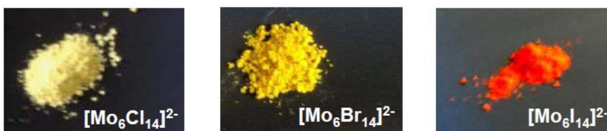
Figure 135 : Photographies des poudres de composés à clusters octaédriques de molybdène de types [(M_6L_8)L^a_6]^{2-} ( L = Cl, Br, I )
