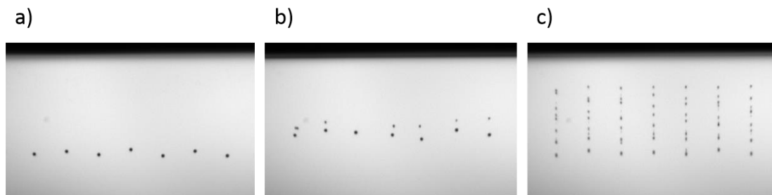
Figure 28 : éjection de gouttes d'encre d'argent (ANP 40LT15C) à 1 kHz pour différentes tension d'actuation : a) 50V, b) 60V, c) 70V.
