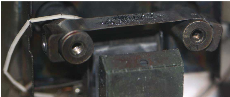
Figure IV-18. Ruban de Pt avec échantillon revenu à température ambiante après ré-oxydation. La transformation de la poudre fine de départ en gros cristaux désolidarisés permet d'expliquer la chute d'intensité.
