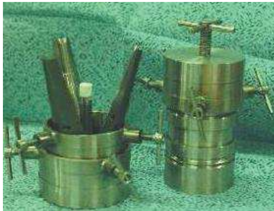
Figure I-11. Photographie d'un moule tricoquille utilisé pour le pressage uniaxial de pastilles à base d'U et d'Am en caisson blindé.
