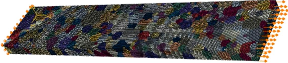
*Figure 168 : Paramètres du maillage et condition aux limites appliquées sur l'éprouvette E2.*
