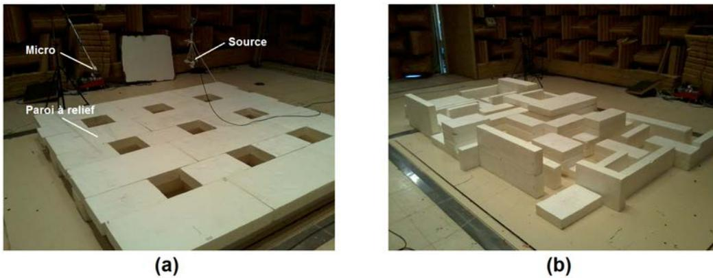
FIGURE A.2 – Deux parois à relief étudiées dans la salle semi-anéchoïque. (a) Résonateurs ; (b) Profil aléatoire.
