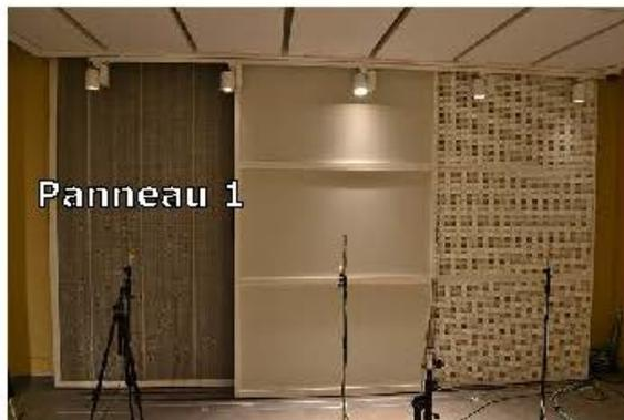
FIGURE 4.25 – Trois configurations de panneaux étudiées dans la chambre sourde.
