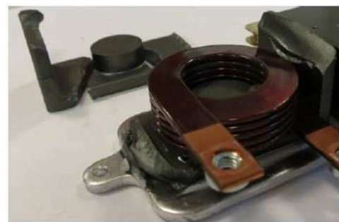
(b) Rupture de l'inducteur de puissance
