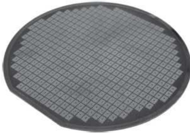
FIGURE 1.2: Exemple d'une plaquette de silicium (silicon wafer)
