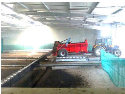
(c) Banc de mesure transversal CEMOB décrit par la norme EN 13739-2.
