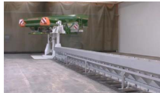
(d) Banc de mesure radial CEMIB développé par Piron et al. (2010), installé chez Amazone-Werke.
