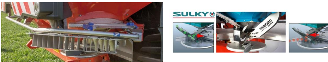
(a) TELIMAT de Rauch pour la déviation de la trajectoire des particules. (b) TRIBORD de Sulky utilisant des pales différentes sur le disque.
