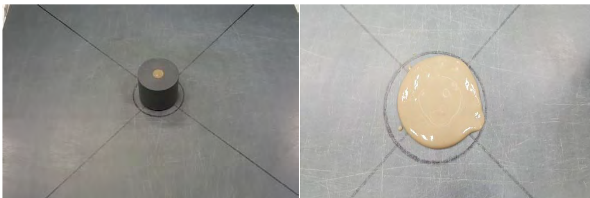
Figure B1- 14 : Illustration d'un essai d'étalement au mini-cône
