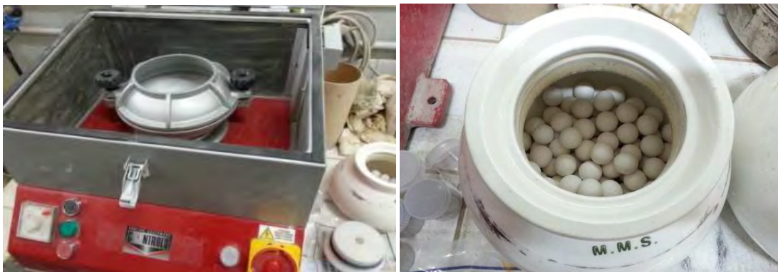
Figure C2- 1 : Broyeur planétaire avec billes en porcelaine
