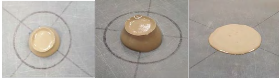
Figure C2- 15 : Illustration du manque de fluidité de certaines pâtes pour l'étalement au mini cône
