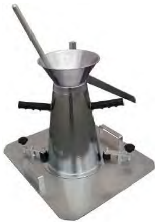
Figure B1- 19 : Cône d'Abrams
