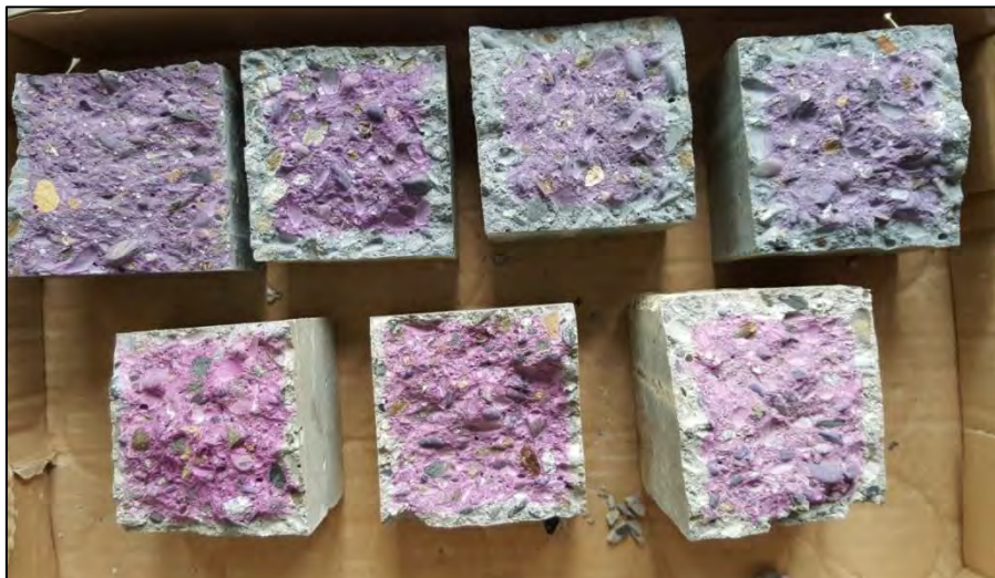
Figure B1- 21 : Mise en évidence de la carbonatation d'éprouvettes après pulvérisation à la phénolphtaléine (zone colorée non carbonatée)
