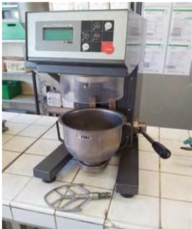
Figure B1- 6: Malaxeur normalisé CONTROLAB
