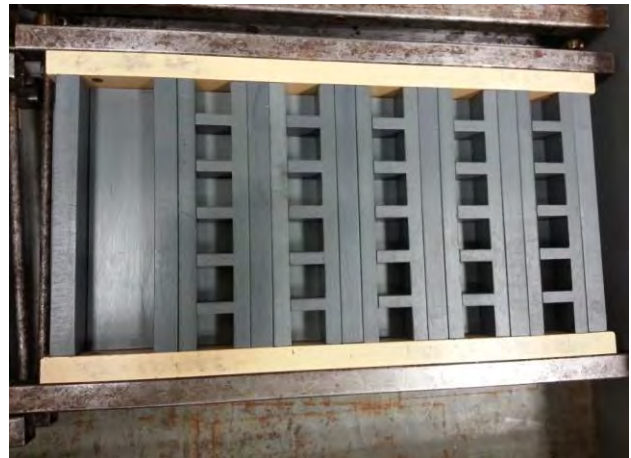
Figure B1- 7: Moule mortiers modulable en 2*2*2cm ou 4*4*16cm
