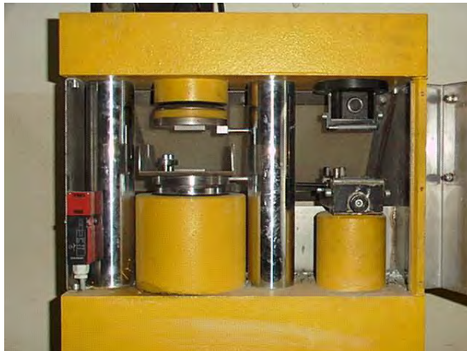
Figure B1- 18 : Presse à mortier automatisée pour les essais de résistance en compression
