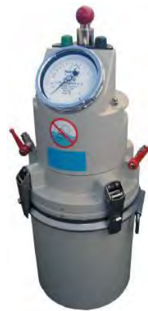
Figure B1- 20 : Aéromètre
