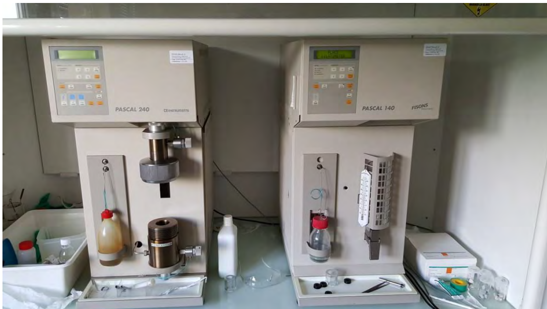
Figure B1- 24 : Porosimètre à mercure PASCAL 140 et 240
