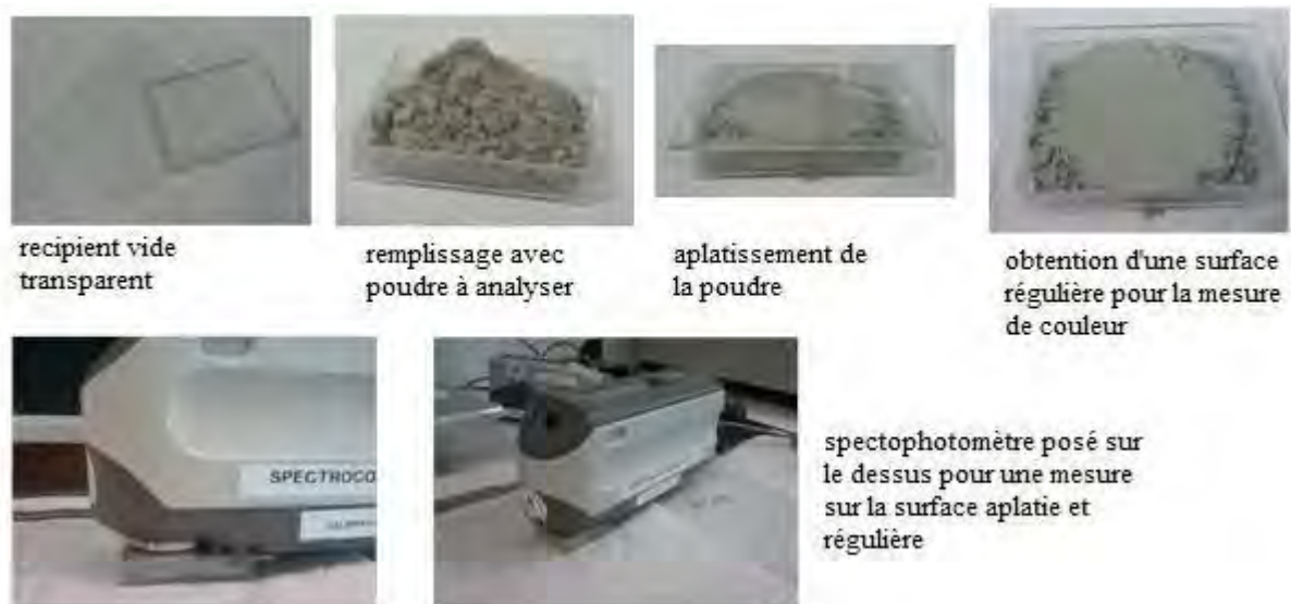
Figure B1- 4 : Protocole de mesure de colorimétrie sur poudres
