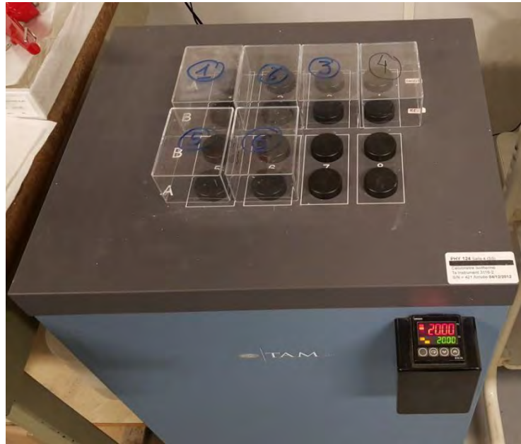
Figure B1- 13 : Appareil de mesure pour la calorimétrie isotherme avec 8 voies de mesures contenant une cellule pour la référence et une cellule pour l'échantillon de pâte
