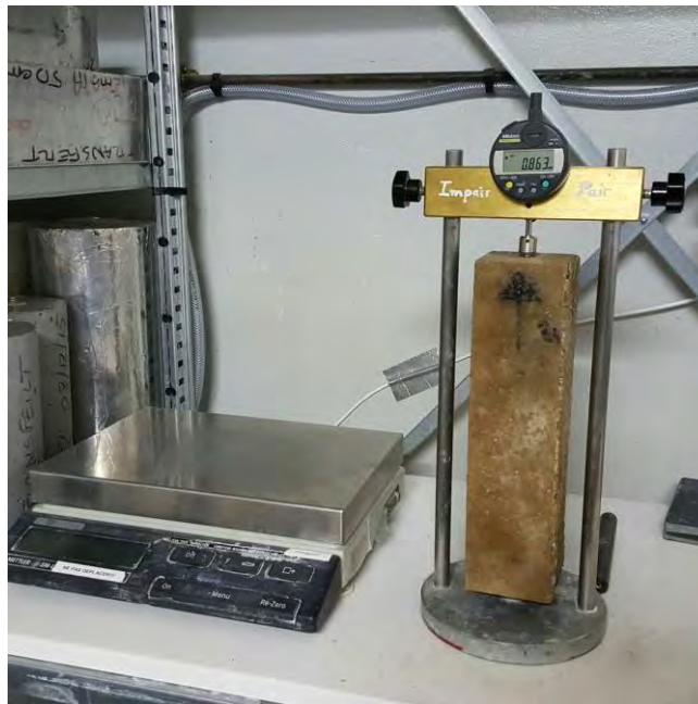
Figure B1- 27 : Mesure de l'expansion d'une éprouvette grâce aux plots insérés lors du coulage
