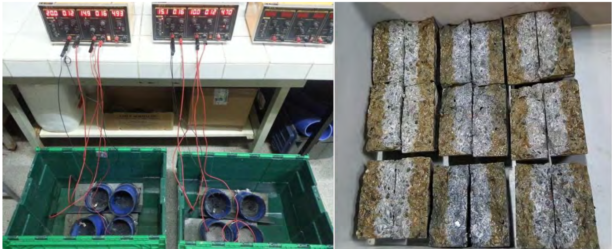
Figure B1- 25 : Dispositif de mesure du coefficient de migration des chlorures et éprouvettes après pulvérisation du nitrate d'argent mettant en évidence la pénétration des ions chlorures
