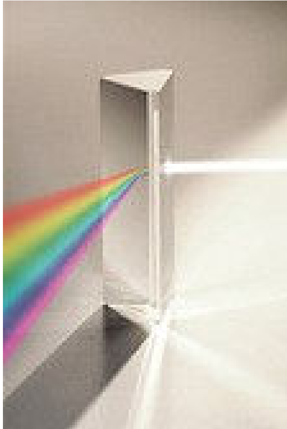
1 Prisme triangulaire dispersant un rayon lumineux
