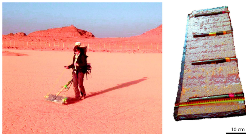
FIGURE 6.10 – Photographie du système de mesure à gauche et photographie de la disposition des capteurs dans la perche à droite.
