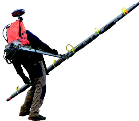
FIGURE 4.10 – Dispositif d’acquisition placé sur un sac-à-dos, équipé de huit capteurs.
