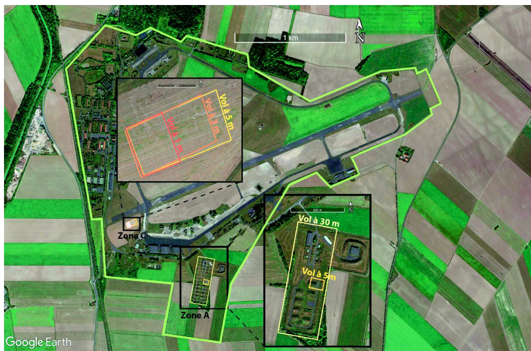
FIGURE 4.9 – Localisation des routes suivies par le drone matrice 100, lors des cinq vols à différentes altitudes (du 23 au 26 janvier 2017) superposée à la photographie aérienne (Google Earth). La ligne verte indique l'emprise de l'ancienne base aérienne.
