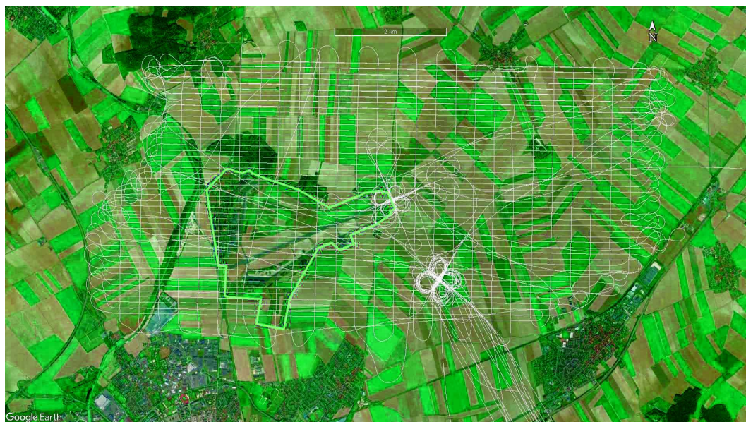
FIGURE 4.4 – Localisation des routes suivies par l'ULM superposée à la photographie aérienne (Google Earth) lors de la campagne de mesure des 15 et 16 juin 2015. La ligne verte indique l'emprise de l'ancienne base aérienne.
