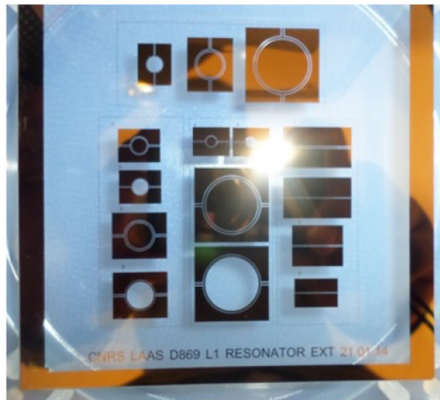
FIGURE 2.36 – Masque optique sur verre pour la photolithographie des structures résonantes
