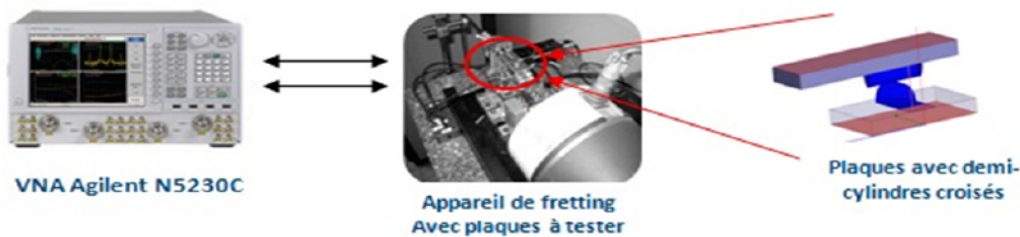
FIGURE 3.28 – Banc de fretting HF avec la structure en demi-cylindres croisés sur lignes microrubans
