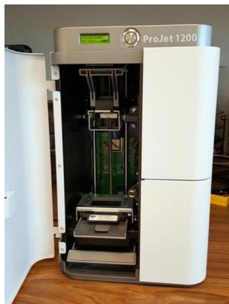
**Figure 68 : Imprimante 3D utilisant la stéréolithographie – ProJet 1200 (UBO Openfactory)**
