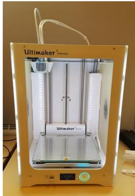
**Figure 67 : Imprimante 3D utilisant la technique du fil fondu – Ultimaker 3 (UBO Openfactory)**
