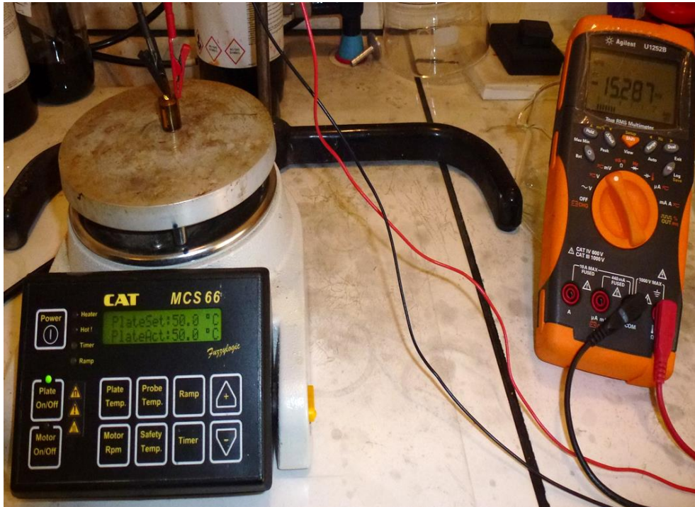
Figure IV.12 : Mesure de la tension thermoélectrique du module de 2,9 \text{ k}\Omega en conditions réelles avec comme source de chaleur la plaque chauffante fixée à 50 \text{ }^\circ\text{C} . Au moment du cliché, le voltmètre affiche 15,287 \text{ mV} , ce qui représenterait environ 20,1 \text{ nW} aux bornes d'une résistance de charge de 2,9 \text{ k}\Omega .
