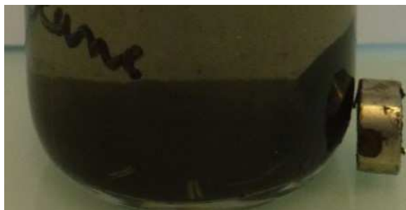
FIGURE 4.3 – Photographie attestant les propriétés magnétiques des Cu@CuNiNF
