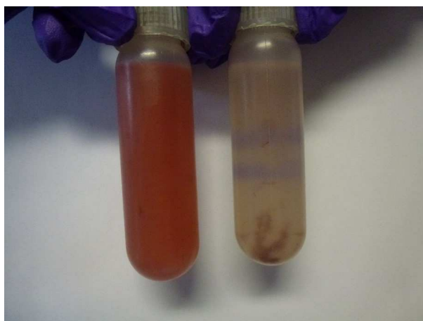
FIGURE 2.12 – Photographie de nanofils dispersés dans l'acide chlorhydrique (à gauche) et dans l'acide acétique glacial (à droite)
