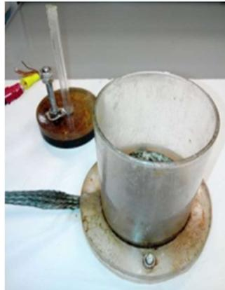
Figure II. 7 :Chambre de traitement en batch
