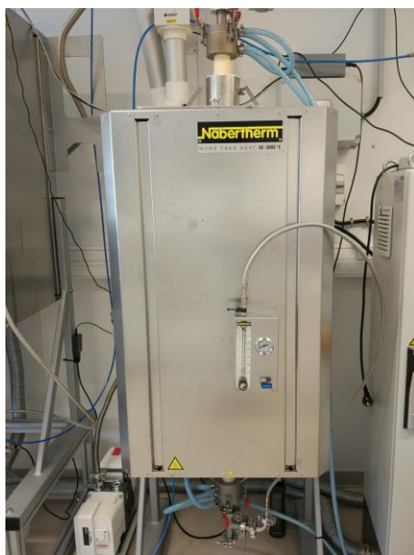
Figure V-29 : Four tubulaire vertical Nabertherm utilisé (à gauche) et schématique (à droite)
