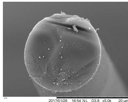
Figure V-33: Fibre de LIG/40PEBA carbonisée
