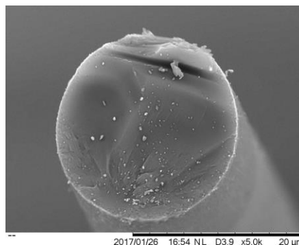
Figure V-33: Fibre de LIG/40PEBA carbonisée
