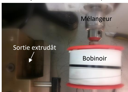
Figure V-27 : Système de filage sur mini-extrudeuse
