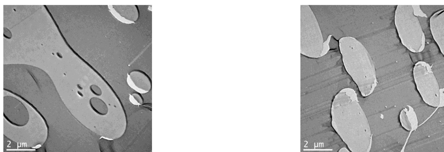
Figure VI-11 : Clichés MEB de mélanges de lignine butyrate avec 25% m de PLA à gauche et 10% m de PLA à droite[9]
