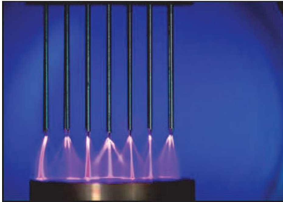
FIGURE 2.2.1 – Photographie d'une décharge corona multi-pointes pulsée au laboratoire LAPLACE. Conditions expérimentales : tension d'alimentation 8kV, durée d'impulsion 40 \mu s, fréquence de répétition 100Hz, distance anode/cathode 8mm et rayon de courbure des pointes 25 \mu m, 14 pointes disposées en deux rangées de 7 pointes. D'après[6]
