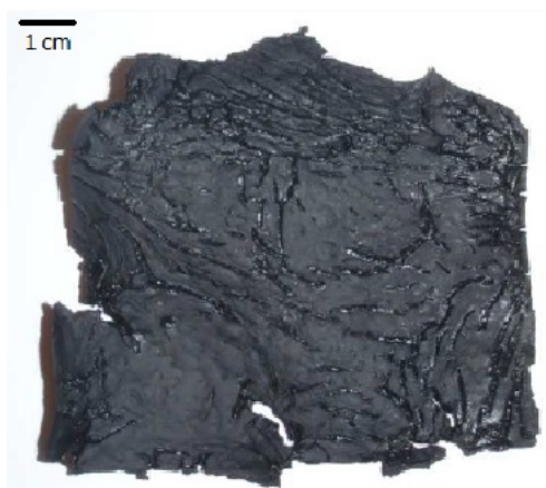
FIGURE I.39 – Fissuration d'un polychloroprène vieilli en eau de mer [127]
