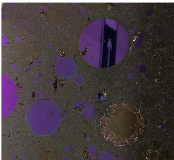
*FIGURE 4. Surface du substrat observée après un procédé de retrait sans puissance radiofréquence. Ceci revient à observer uniquement l'effet de la température*
