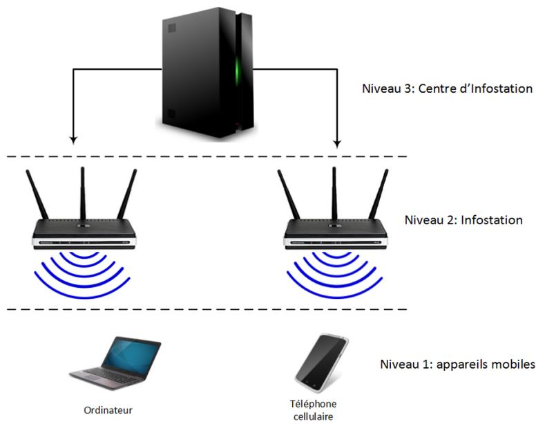
Figure 2.2 – Architecture à 3 niveaux d'un réseau d'infostations.
