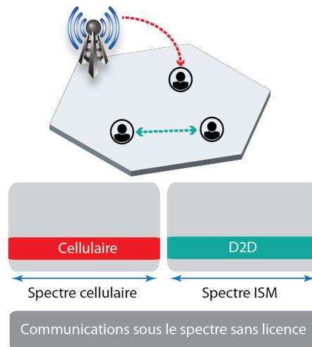
Figure 2.7 – Communications D2D : utilisation d'un spectre sans licence.
