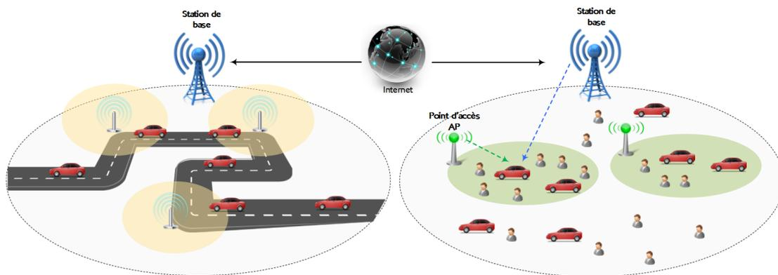
Figure 2.3 – Scénarios de délestage de données (*mobile data offloading*).
