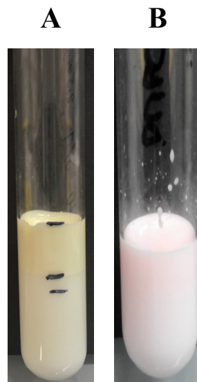
Figure 2 : Aspect visuel des émulsions testées pour représenter un modèle d'émulsion alimentaire avec le DMPC comme émulsifiant : DMPC/huile d'olive (A) et DMPC/GT en présence de Rouge de Nil (B). Les deux traits noirs sur le tube de la photo B représentent la zone de crémage de l'émulsion. Rapport volumique huile/eau 1/5, [DMPC] = 5 mg/mL.
