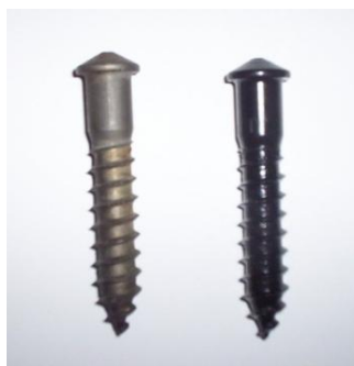
Figure I- 3 : Vis avant cataphorèse (gauche) et après cataphorèse (droite)
