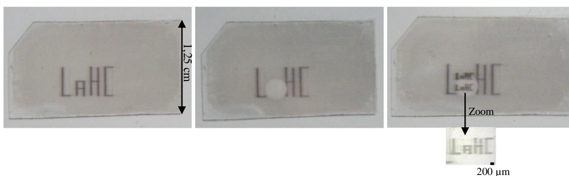
Figure 4-15 : Exemple d'inscription par insolation à 244 nm et effacement à 488 nm sur un film BzAc/flexographie/Recuit IR.
