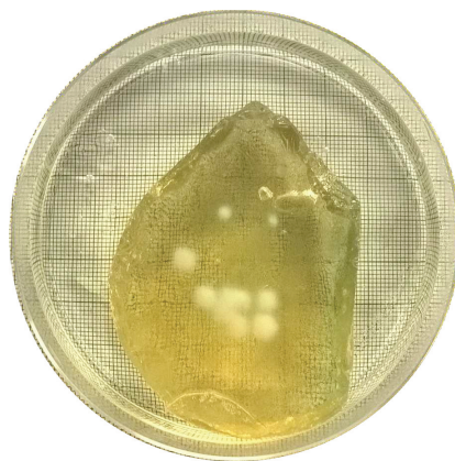
FIGURE 3.2 – Le gel thermosensible PAG-BSA est composé d'une matrice transparente qui blanchit après une évolution de température suffisamment importante. En ultrason thérapeutique, on s'en sert notamment comme d'un outil d'étude de formation de lésions thermique, comme ici en blanc dans cet exemple.
