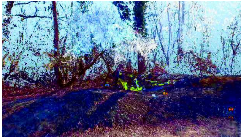
Figure 3 - Colorisation du nuage de point obtenu par lasergrammétrie.
