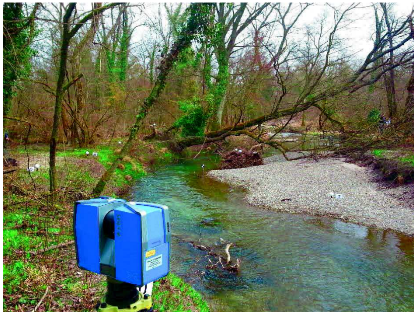
Figure 2 : Acquisition lasergrammétrique (Faro Focus 3D) sur le tronçon C.
