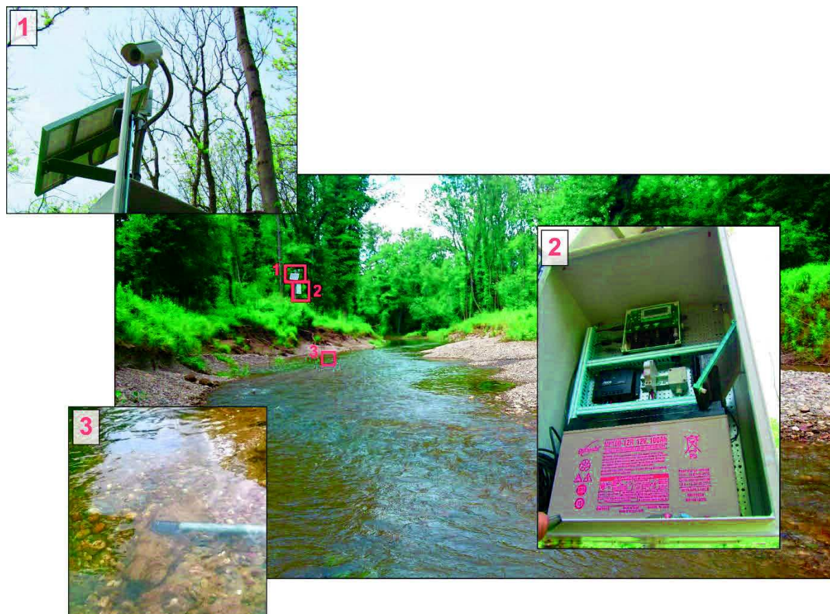
Figure 5. 5 - Dispositif de surveillance vidéo et d'acquisition de données acoustiques. (1) Panneau photovoltaïque et caméra de surveillance téléconnectée ; (2) Dispositif de stockage de l'énergie solaire (batterie au bas de l'image) et boîtier d'acquisition de l'hydrophone (en haut de l'image) ; (3) Micro immergé.
