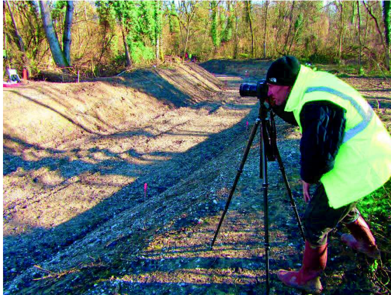
Figure 4 - Acquisition photogrammétrique (Canon EOS 5D Mark II) sur le tronçon A
