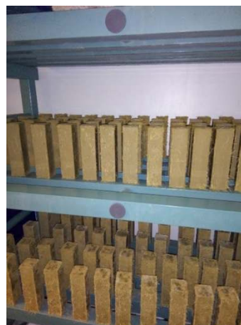
Figure II. 23 : Les éprouvettes dans la chambre climatique à une température de 20^{\circ}\text{C} \pm 1^{\circ}\text{C} et une humidité relative de 90\% \pm 5\%
