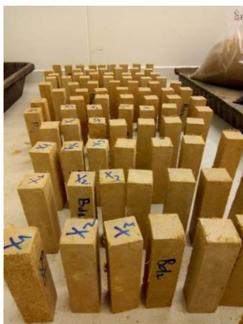
Figure II. 22 : Les éprouvettes dans la chambre climatique à une température de 20^{\circ}\text{C} \pm 1^{\circ}\text{C} et une humidité relative de 50\% \pm 5\%
