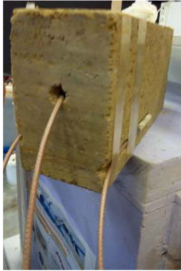
Figure V. 9 : Photo de la brique comportant des sondes placées au milieu de la paroi
