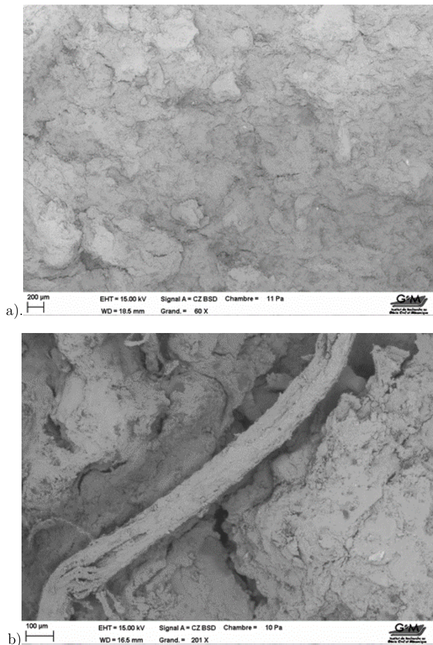
Figure IV. 8 : Image MEB de la face de rupture d'une BTC après un essai de flexion 3 points – a) sans fibre ; b) avec fibres
