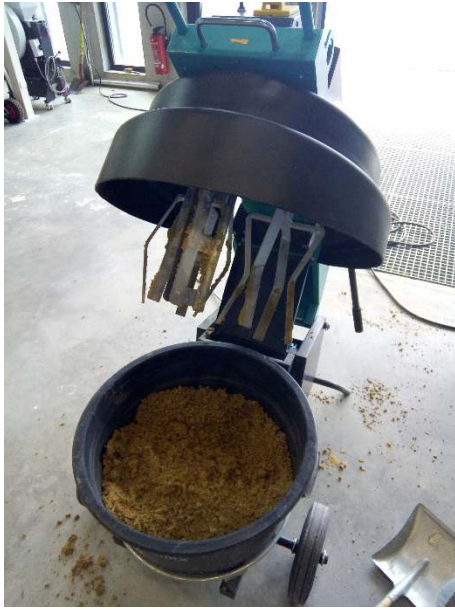
Figure II. 20 : Malaxeur ayant servi à élaborer les blocs
