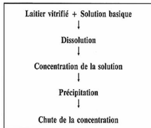
Figure I. 28 : Prise du laitier [71]
