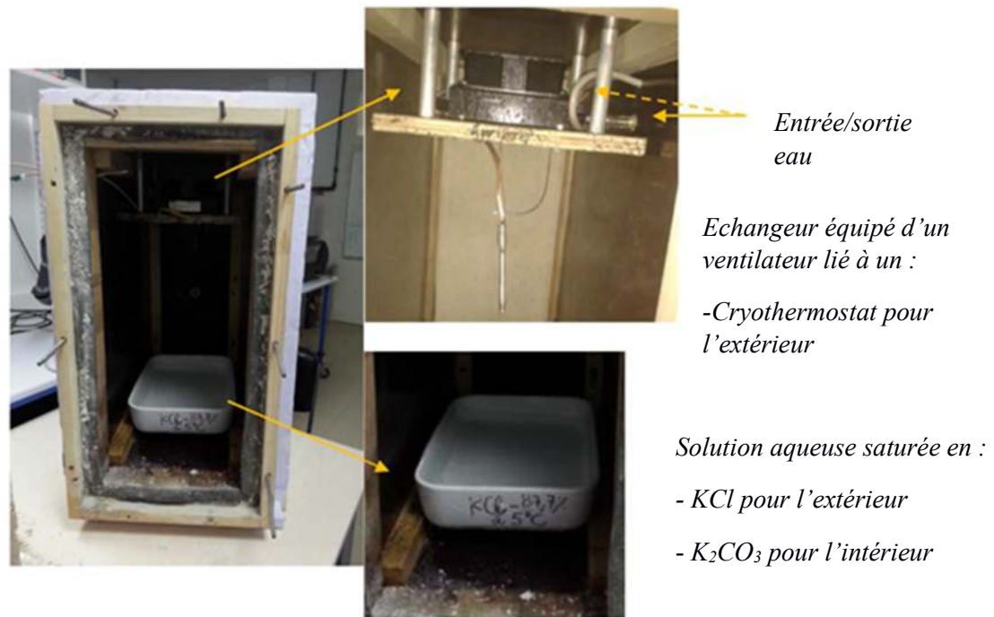
Figure V. 8 : Photo du principe de génération de température et d'humidité relative
