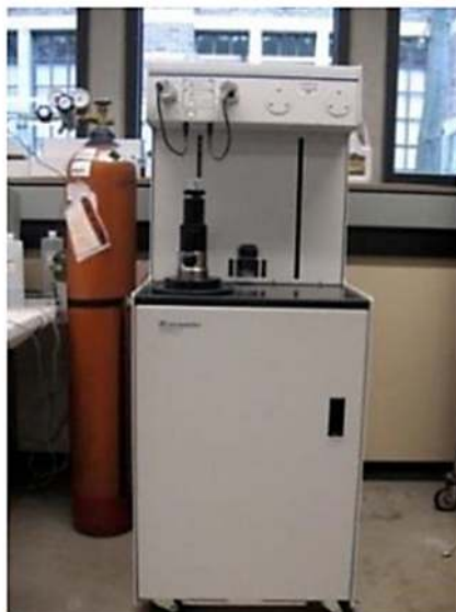
Figure II. 30 : Descriptif d'un prosimètre au mercure utilisé
