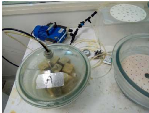
Figure II. 31 : Dispositif de saturation pour la détermination de la porosité accessible à l'eau
