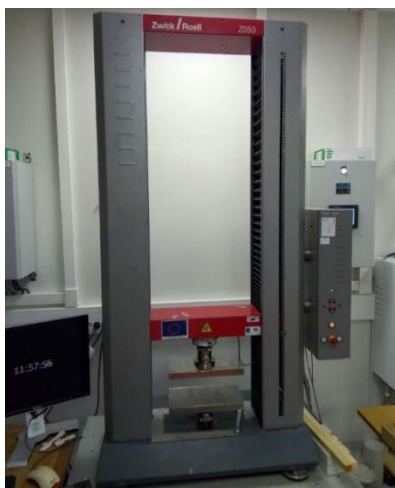
Figure II. 19: Presse pour la confection des BTC et pour les essais de flexion et de compression
