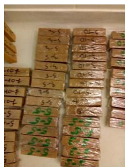
Figure II. 24 : Les éprouvettes recouvertes des films en plastique dans la chambre climatique à une température de 20^{\circ}\text{C} \pm 1^{\circ}\text{C} et une humidité relative de 50\% \pm 5\%
