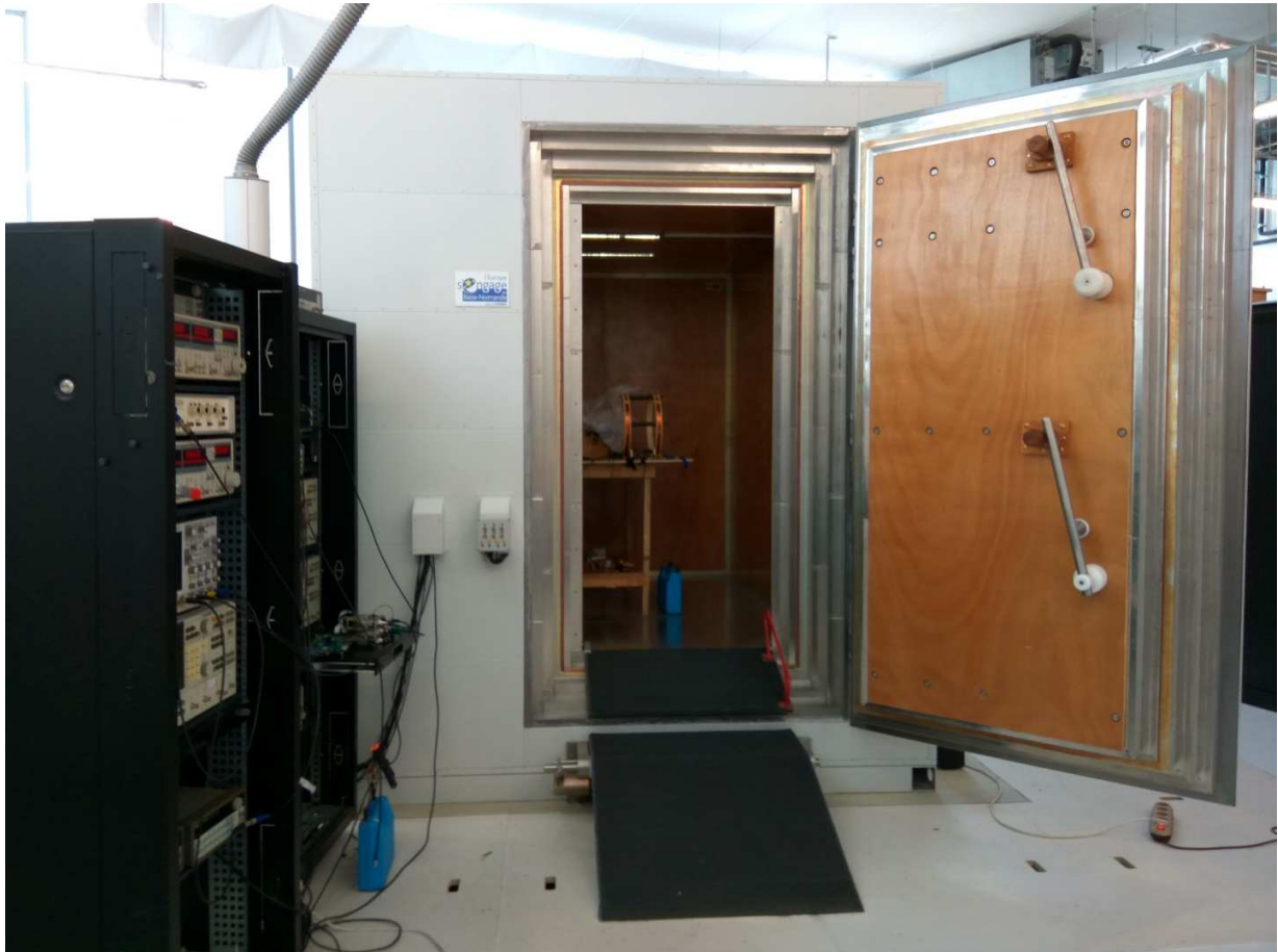
Figure 1 : Photographie de la chambre blindée
