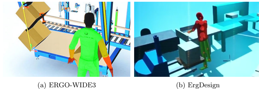
FIGURE 2.19 – Mesure de l'ergonomie d'un poste de travail en environnement virtuel
