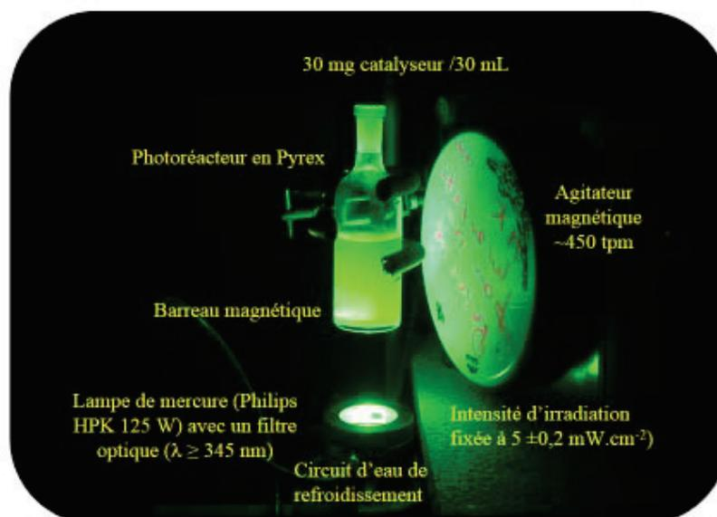
Figure II-11- Dispositif expérimental du réacteur photocatalytique.
