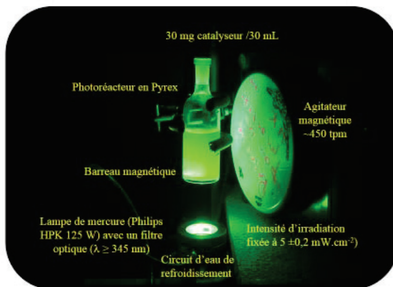
Figure II-11- Dispositif expérimental du réacteur photocatalytique.
