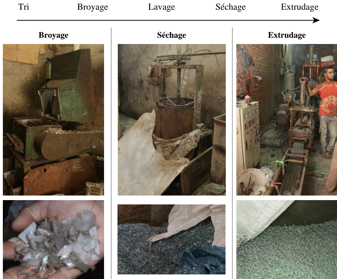
Fig. 32 : Les transformations du plastique : broyeuse (à gauche) pour casser le plastique en morceaux grossiers avant le lavage ; essoreuse (au milieu) pour sécher après le lavage et extrudeuse (à droite) permettant de le fondre en billes commercialisables (© David Degner / décembre 2014)
