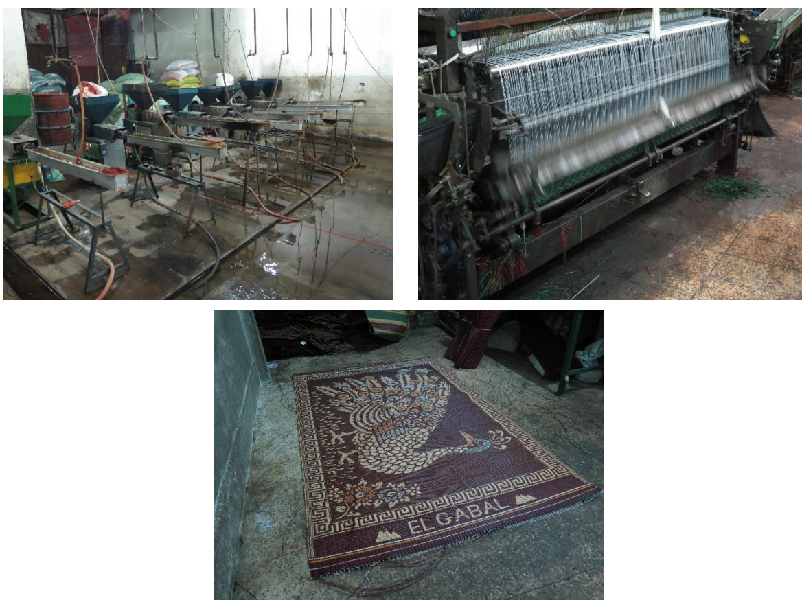
Fig. 40 : Fabrication de tapis en plastique à partir des matériaux recyclés de Manshyet Nasser mélangés à des résines neuves (© David Degner / décembre 2014)
