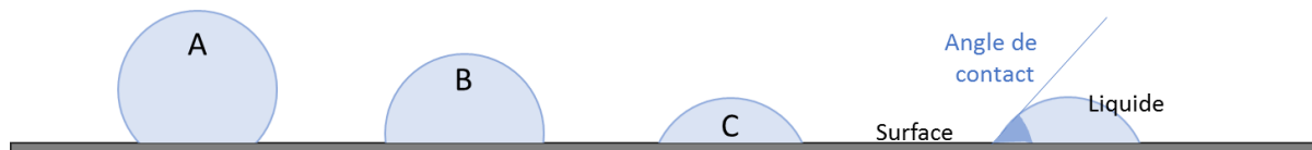
Figure III-30 : Principe de la mesure d'angle de contact, A = forme d'une goutte sur une surface superhydrophobe ( > 150^\circ ), B = forme d'une goutte sur une surface hydrophobe ( > 90^\circ ) et C = forme d'une goutte sur une surface hydrophile ( < 90^\circ )
