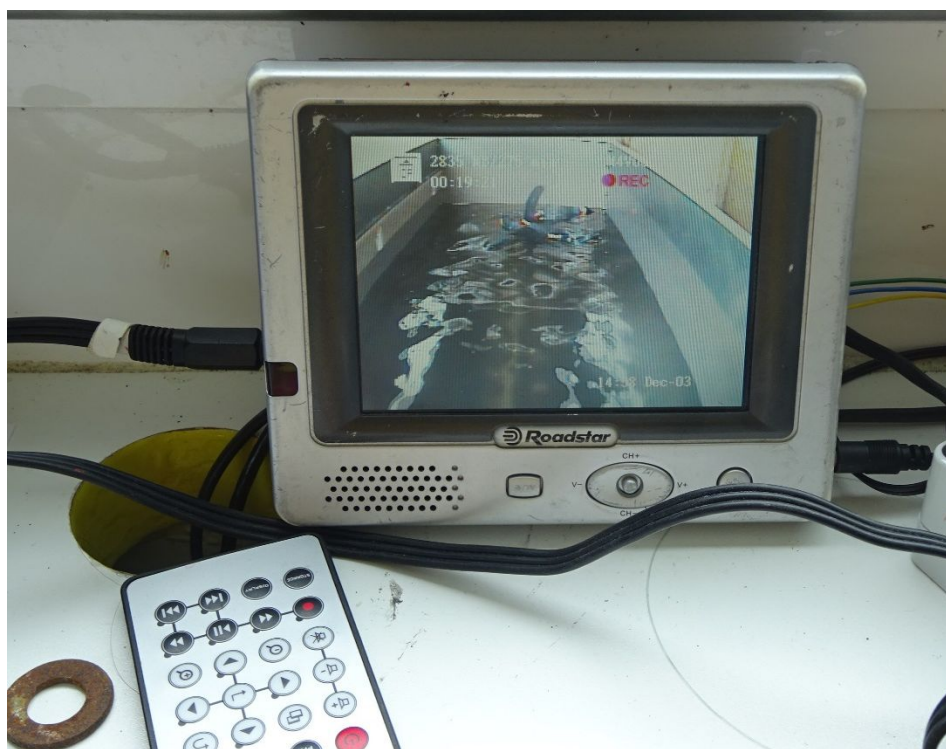
Figure 36 : Moniteur situé dans le bureau/laboratoire permettant une surveillance des individus en piscine à distance et une intervention rapide en cas de besoin
