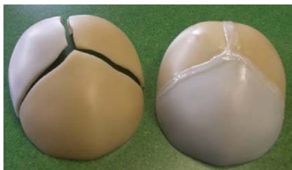
Figure 19 : Substitut physique du crâne humain composé de 3 résines différentes.[Del07]
