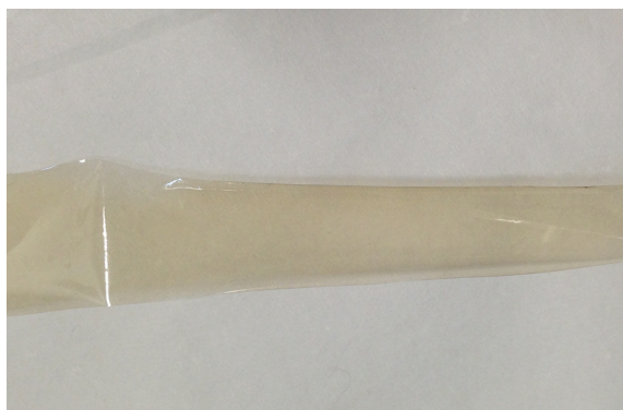
Figure 45. Exemple de membrane fine obtenue après la mise en œuvre dans la DMAc des polymères obtenus
