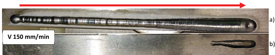
Figure 3.4 Aspect du cordon lorsque la vitesse d'avance est trop faible, produisant un affaissement en face envers de la tôle support (point de fonctionnement 5), (a) face endroit, (b) face envers
