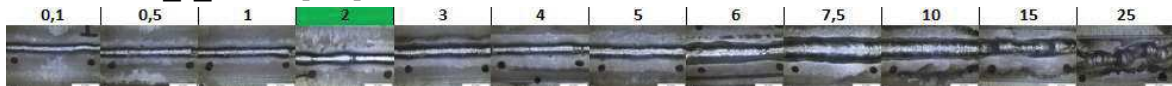
Figure A2.19: Evolution de la géométrie de cordon pour différentes valeurs de t_{I_{boost}}
