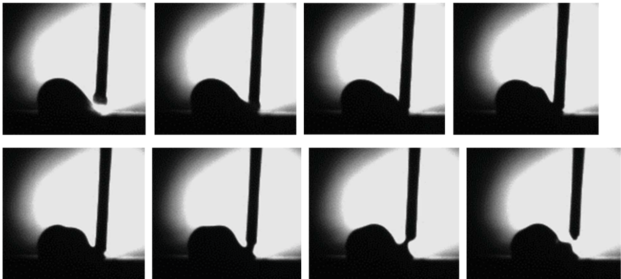
Figure 4.7 Migration de la goutte de liquide déposée à l'avant vers l'arrière de la macro-goutte venant amplifier le défaut en début de cordon
