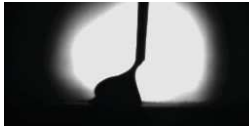
Figure 4.60 Formation d'un pont liquide de plus en plus étroit sous l'effet de la remontée du fil avant la rupture du court-circuit
