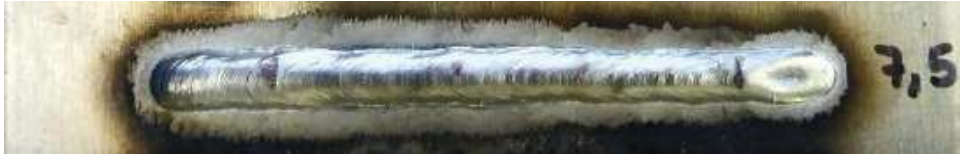
Figure 4.59 (a) Fluctuations de la durée de la phase boost associée au détachement de gouttes pendant la phase boost sous l'effet d'une énergie d'arc trop élevée, (b) aspect des cordons obtenus
