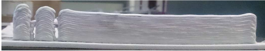
Figure 2.12 : Préparation de la pièce par pulvérisation d'un spray de couleur blanche
