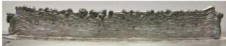
Figure 5.40: Défauts formés dans un mur de 30 cordons superposés réalisé avec le point de fonctionnement 5 à la vitesse de 2400 mm/min
