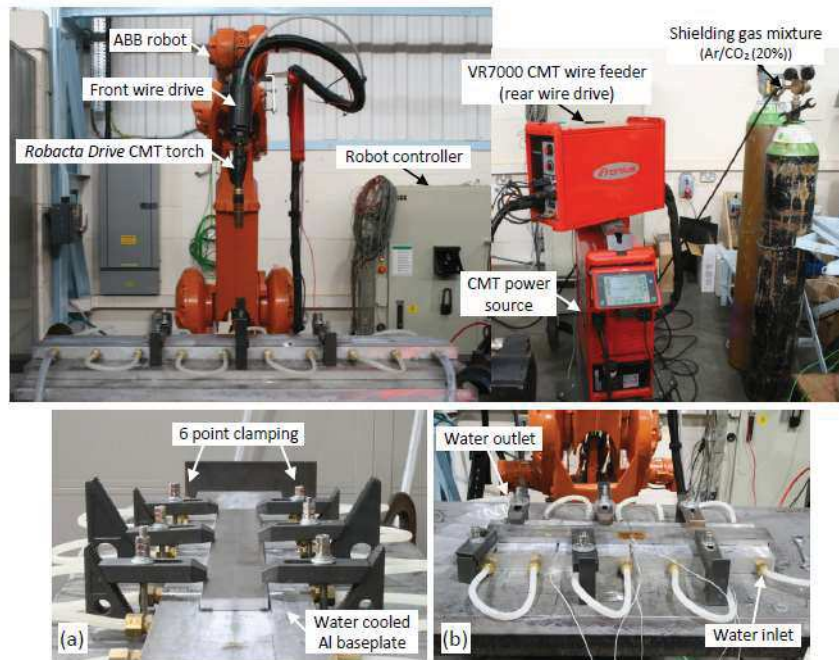
Figure 1.28 : Système de refroidissement par eau du plateau de construction permettant de diminuer les temps de refroidissement [71]
