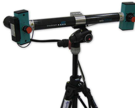
Figure 2.11 : Photo du scanner 3D BREUCKMANN OPTO TOP-HE utilisé pour la numérisation des pièces
