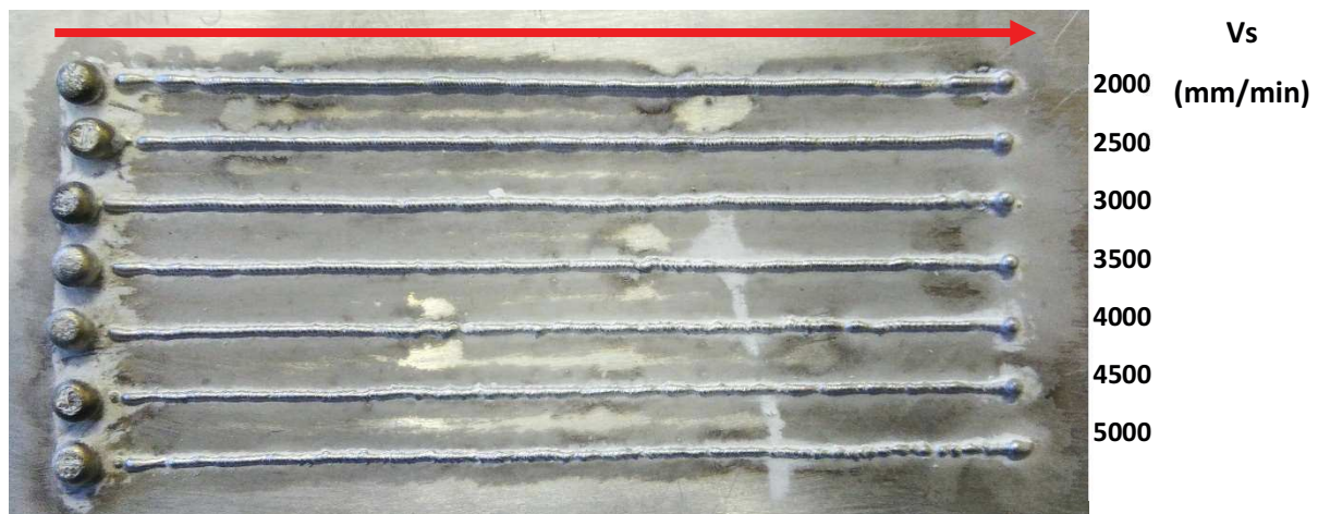
Figure 3.3 Aspect des cordons déposés avec le point de fonctionnement 5 en « préchauffant » la tôle grâce à un maintien statique de la torche pendant 2 secondes en début d'essai
