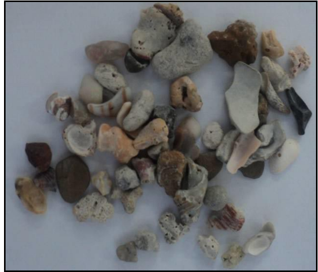
Photo 41: Débris coquilliers extraits d'un échantillon de la Cocoteraie.
