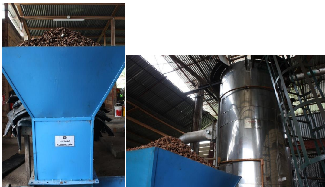
Photographie 26 : Les chaudières, alimentées par les cosses, pour sécher et ramolir les noix d'Amazonie
