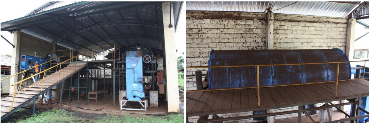
Photographie 24 : Séchage des noix d'Amazonie dans les cylindres durant 25h
