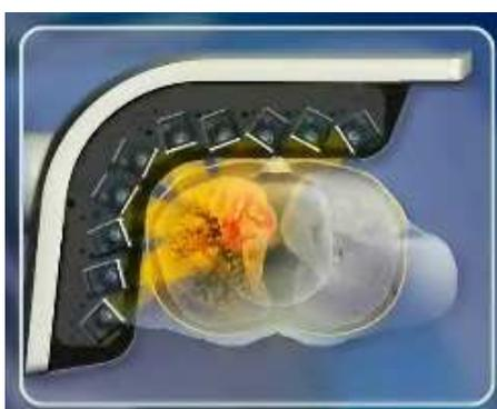
Figure IV-69 : Coupe transverse de la tête de détection la caméra D-SPECT, composée de 10 détecteurs en mouvement.
