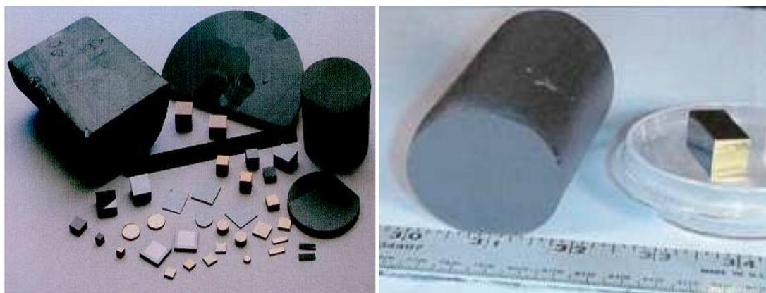
Figure II-7 : Exemple de dimensionnement de lingot CdZnTe (HPBM-CdZnTe d'eV-Products à gauche et MVBM-CdZnTe de Yinnel à droite).
