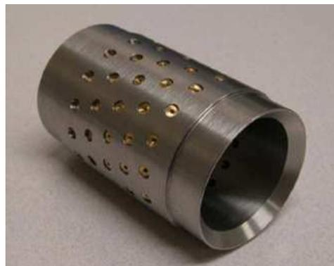
Figure II-21 : Le collimateur U-SPECT-III : 75 pinhole (5 rangée de 15) knife-edges en or sur un support cylindrique en tungstène [Beekman, et al., 2004].
