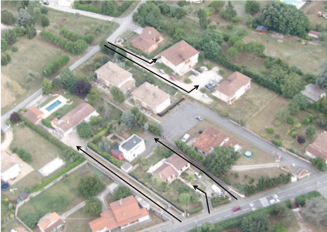
Figure 8 : Photo aérienne d'un quartier de la commune de Bouloc (Haute-Garonne). Les opérations de division parcellaire en « drapeau » sont visibles grâce aux flèches, qui montrent que la multiplication des accès se fait au détriment de la cohérence urbaine. (© Denis Carraire)
