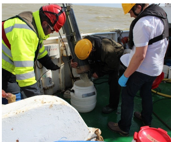
Figure 28 : Prélèvement de grands volumes d'eau pour la récupération de MES à l'aide d'une bouteille Niskin® de 30 L.
