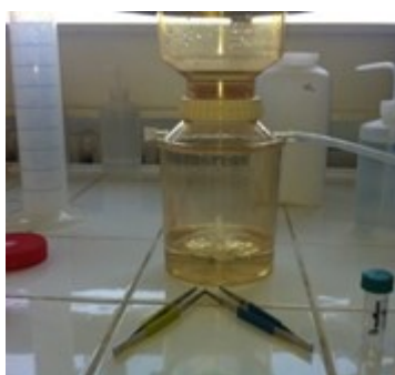
Figure 27 : Unité de filtration utilisée pour la récupération de MES.
