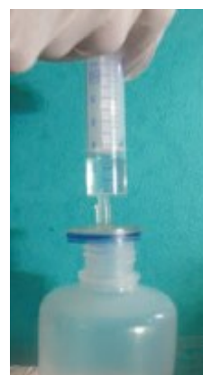
Figure 26 : Filtration de la fraction dissoute à 0,2 \mu m .
