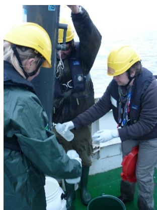
Figure 25 : Prélèvement de la fraction dissoute et des MES à la bouteille Niskin®.
