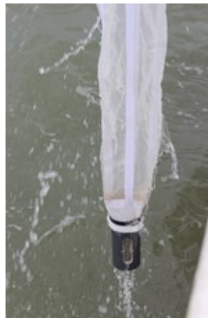
Figure 35 : Récupération de la fraction supérieure à 200 \mu\text{m} à l'aide d'un filet à plancton.
