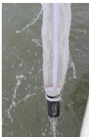
Figure 35 : Récupération de la fraction supérieure à 200 \mu\text{m} à l'aide d'un filet à plancton.
